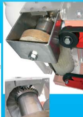
SPAZZOLA ROTANTE DI FINITURA CON TRASMISSIONE A COPPIA CONICA
